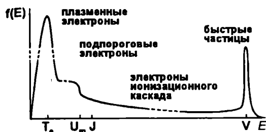
Рис. 3. Качественная картина энергетического спектра электронов при ионизации и возбуждении плотного газа жестким источником. V — энергия быстрых частиц; T_e — температура электронов плазмы; J — энергия ионизации атомов среды; U_m — порог возбуждения атомов среды.
